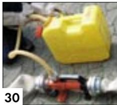
**Zumischer (30)** Bei Löscharbeiten mit Schaum (z. B. bei brennenden Flüssigkeiten oder Fahrzeugen) wird das Löschwasser im Zumischer mit Schaummittel versetzt. Dieses Gemisch wird im → Schaumstrahlrohr zu Schaum.
